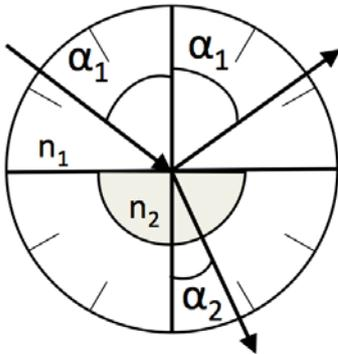
Para asegurarnos de que el montaje es correcto se comprueba que cuando el ángulo de incidencia  $\alpha_1 = 0^\circ$ , el ángulo refractado  $\alpha_2 = 0^\circ$ . La dirección del rayo incidente cuando  $\alpha_1 = \alpha_2 = 0^\circ$  define la dirección del eje óptico y con ello el origen de medida de ángulos de incidencia y refracción. Giramos el disco un ángulo  $\alpha_1 = 30^\circ$  y comprobamos que el rayo reflejado también mide  $30^\circ$  respecto al eje. Ya se puede empezar a medir.
