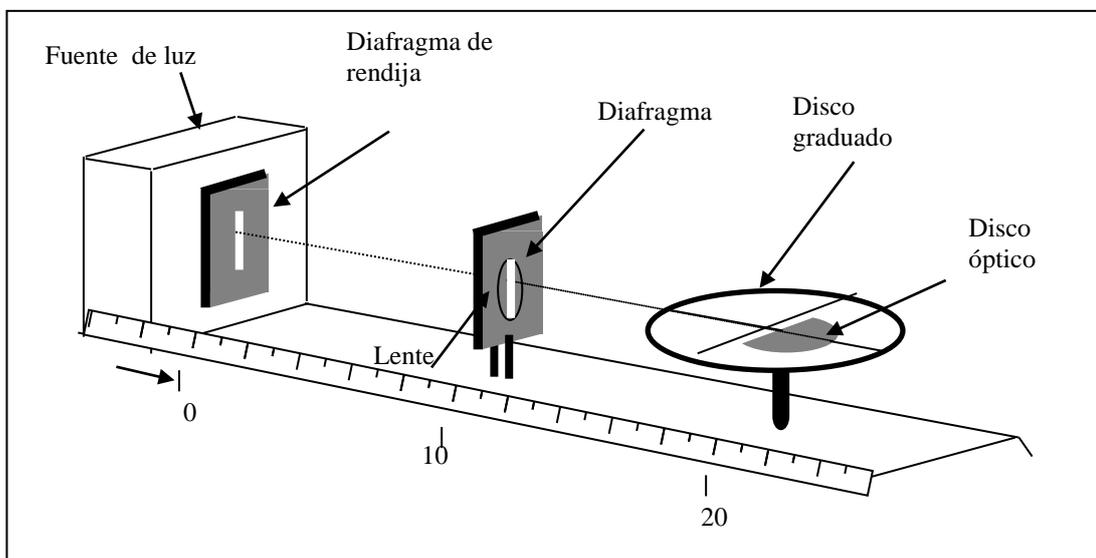
A la derecha de la lente se sitúa el disco graduado (goniómetro) con el pie magnético de la rendija ligeramente inclinado de manera que el haz incida a ras con el disco, asegurándose de que dicho haz pase exactamente por el centro del disco óptico graduado. De esta forma, aparecerá una traza luminosa como "rayo de luz" sobre el disco graduado, la cual debe quedar alineada con uno de sus diámetros.
