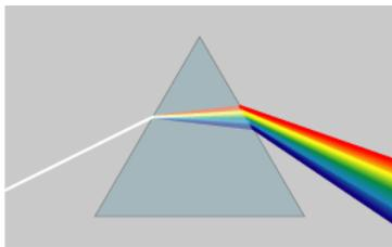
Cuando sobre un prisma incide luz no monocromática, como es el caso de la luz blanca procedente de una lámpara de incandescencia, en cada una de las interfases vidrio-aire cada uno de sus componentes se refracta con un ángulo distinto, saliendo en abanico; pueden observarse unas franjas luminosas de diferentes colores, fenómeno que recibe el nombre de *dispersión*. En este fenómeno de
