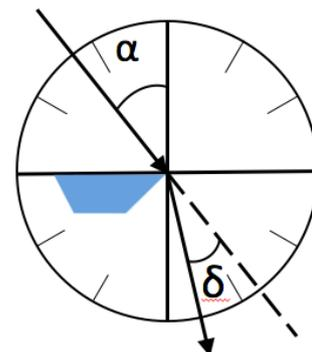
paralela quede perpendicular a la dirección de incidencia. Los ángulos diedros del prisma son  $45^\circ$  y  $60^\circ$ , y nuestro estudio de desviación se hará sobre el ángulo  $A = 45^\circ$ . Para que el ángulo de desviación pueda medirse correctamente, debe provenir del centro del disco; por lo que el vértice del prisma debe colocarse lo más cerca del centro posible.
