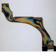
Medida de tensiones mediante efecto fotoelástico
