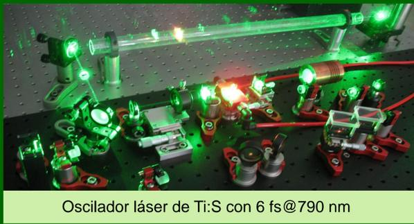
Oscilador láser de Ti:S con 6 fs@790 nm
