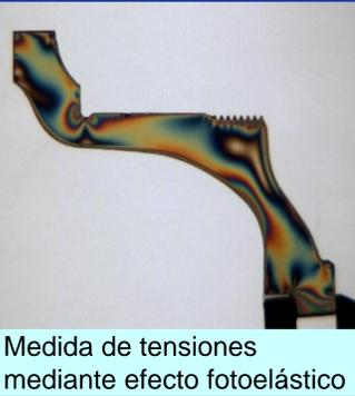
Medida de tensiones mediante efecto fotoelástico
