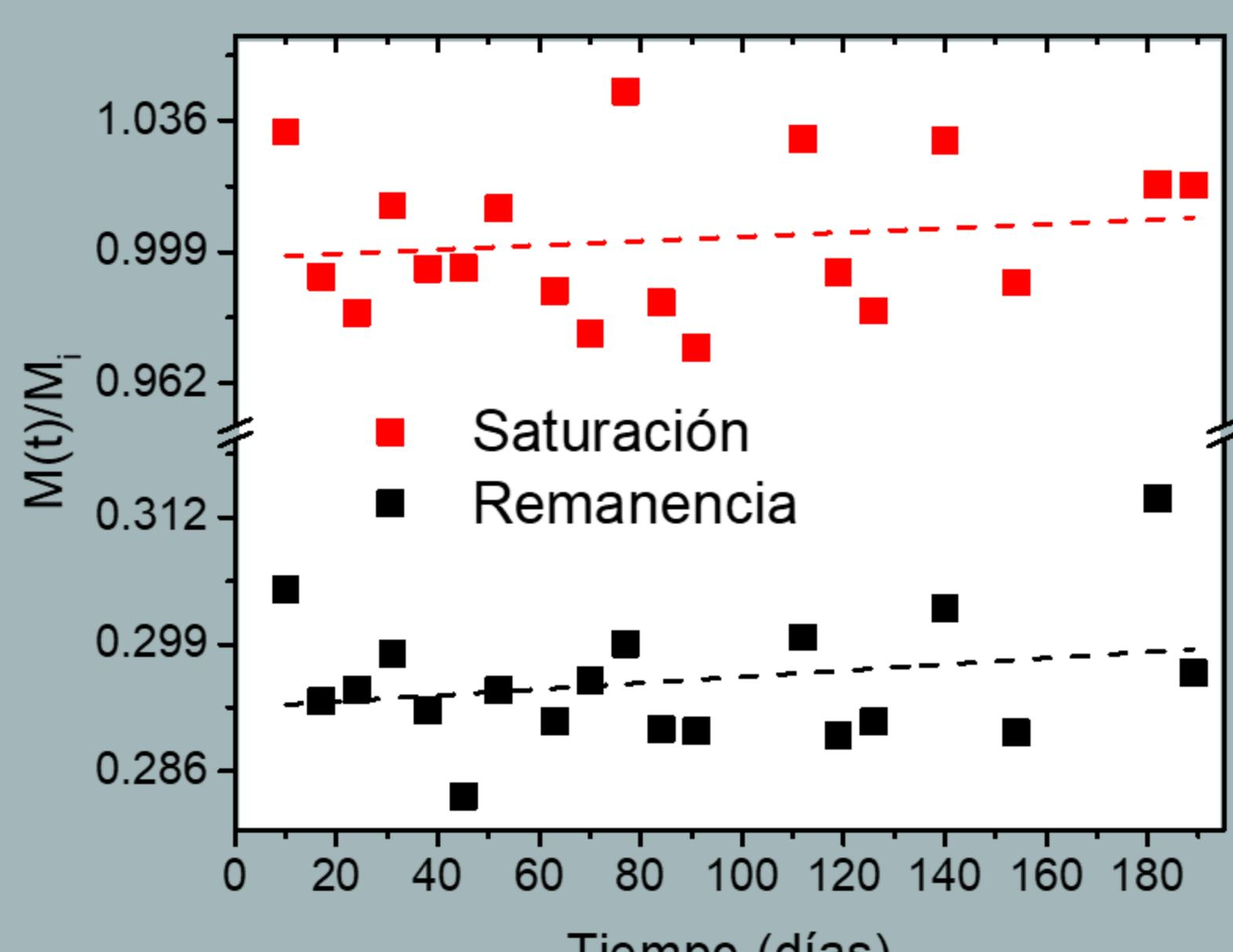
Tras 190 días, la masa sufrió un incremento inferior al 2 %, mostrando una tendencia a estabilizarse. La magnetización y la remanencia no presentan cambios apreciables.
