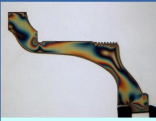
Medida de tensiones mediante efecto fotoelástico
