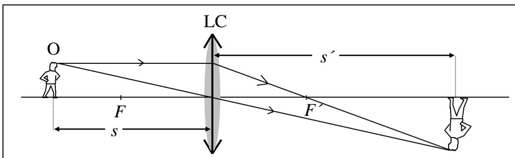
Figura 2: Esquema de la formación de imagen por una lente convergente
