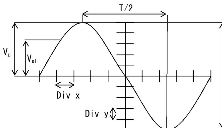
Fig. 2 Señal de CA en el Osciloscopio
